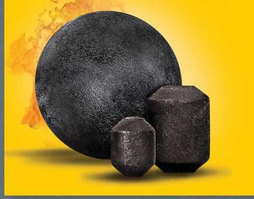
گلوله های فلزی در صنایع مختلف نظیر صنایع معدنی سیمان و فولاد به منظور خردایش مواد برای رسیدن به دانه بندی مناسب مورد مصرف قرار میگیرد این امر با چرخش آسیا و ضربات ناشی از برخورد گلوله ها به مواد داخل آسیا حاصل میگردد لذا بایستی گلوله ها از خواص مکانیکی و مقاومت به ضربه مناسبی برخوردار باشند.
