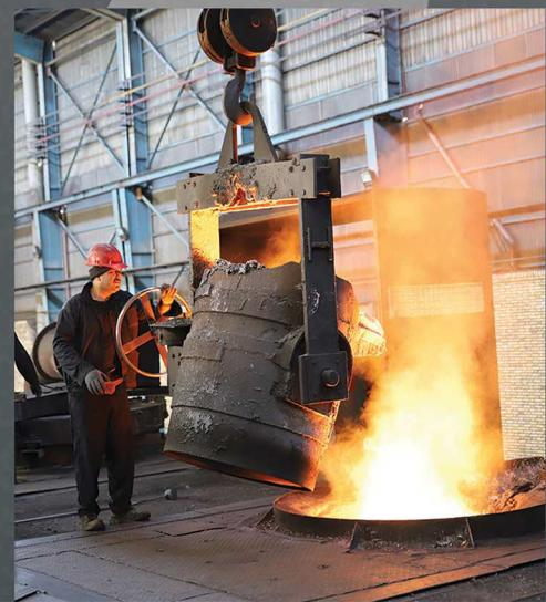
این شرکت از سه خط قالب‌گیری عمودی DISAMATIC استفاده از ۲ مدار ماسه VEBAK و ۳ کوره القانی به ظرفیت هر کدام ۴ تن فرکانس متوسط و یک کوره ۸ تن و ۲ کوره ۶ تن فرکانس متوسط یونکر عملیات تولید ذوب و ریخته گری و در ادامه عملیات تکمیلی حرارتی در یک کوره مداوم تونلی شرکت ایرکست به ظرفیت ۱۵ هزارتن در سال و نیز ۴ کوره عملیات حرارتی غیر مداوم ۱۰ برش خودار می‌باشد.
